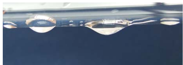
Quarzglas-Hüllrohr ohne T-Tauri Superphobe Beschichtung
