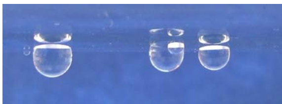
Quarzglas-Hüllrohr mit T-Tauri Superphobe Beschichtung
